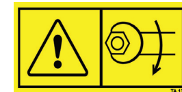
Alle Muttern und Bolzen vor Inbetriebnahme auf festen Sitz kontrollieren
